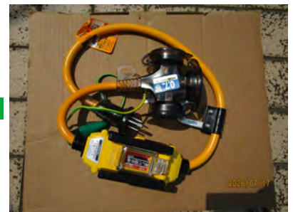
漏電ブレーカー
