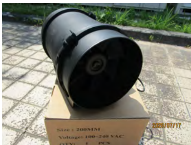
ダクトファン
